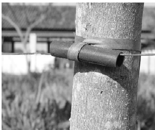
Foto 1. Isolador de tubo eletroduto (1.25 cm de diâmetro).
